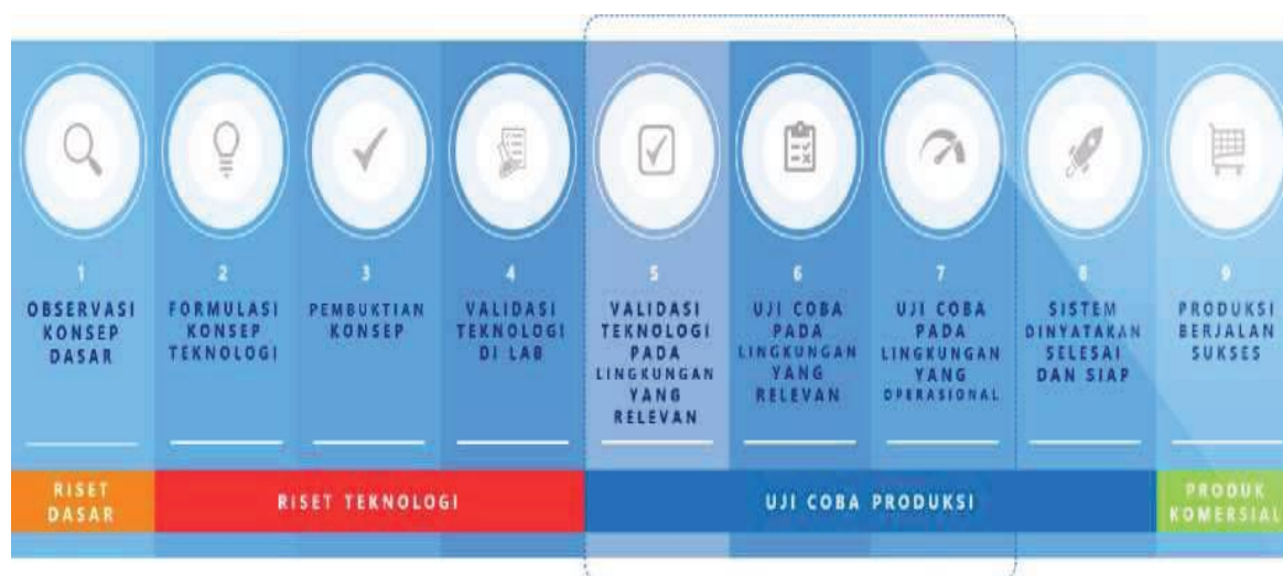
Gambar 2. Level Tingkat Kesiapan Teknologi ( Technological Readiness Level , TRL) Sumber: Buku Putih Sains, Teknologi, dan Pendidikan Tinggi Menuju 2045 (2017, hal.10)
